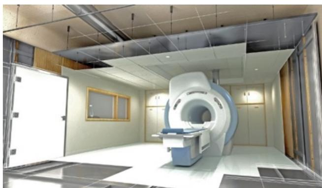
SCHERMATURA RF/RM schermatura con pannelli schermanti in alluminio ed acciaio con imbottitura in poliuretano. Porte Schermate RF sia automatiche che manuali. Visiva Schermata RF con doppi cristalli temperati e doppia rete schermante Impianti Sala RM realizzazione di impianti elettrici e meccanici secondo le normative vigenti per sala di Risonanza Magnetica. Tubo del Quench in acciaio amagnetico AISI304 spessore 2mm per espulsione elio. Schermatura magnetica
